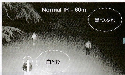
従来の赤外光照明の映像 配光が不均等で、中心部には白とびが、周辺部には黒つぶれがあり、適正な映像エリアは狭く短い。
